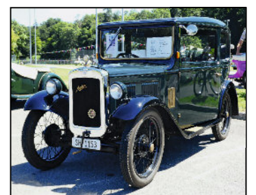
Ein Augenschmaus: Der Wagen der Marke Austin, Model: Seven Saloon, Typ: RN-B5-/1583, Motor: 748 ccm, Leistung: 10 PS, Jahrgang: 1932, Sp mit original Motor und Getriebe. Fotos: ww
